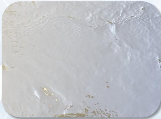
Insufficient dosage No flocs formation
